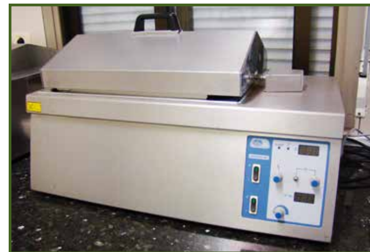
Figura 10. Baño maría para la desinfección de semillas.
